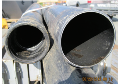
4.9.3. ábra: Átm. 110 mm-es tömör falú, kiásott PP cső Norvégia, Vanvikan. Cső kód: N1
