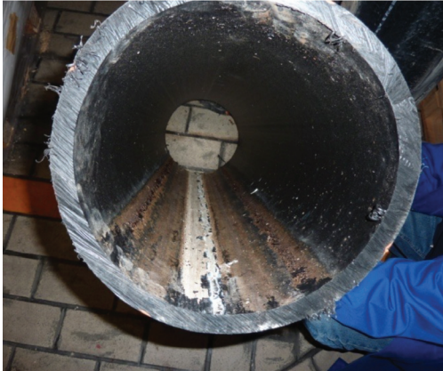
4.7. ábra: Fekete csövek barna csikkokkal. Cső kód: G3
