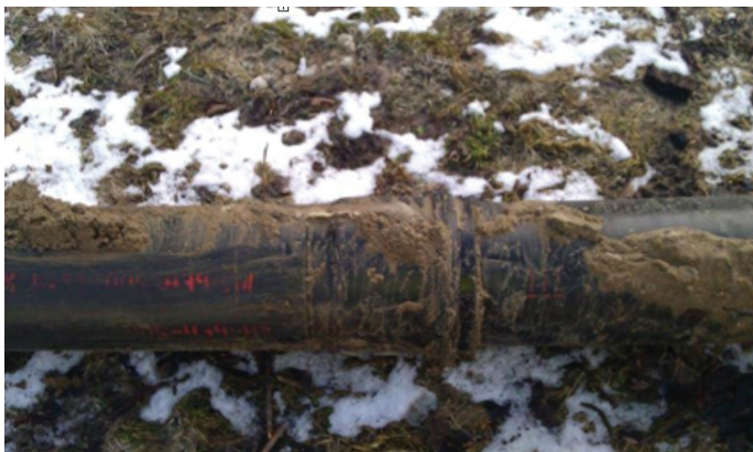
4.2.1. ábra: Kiásott csőkötés.
