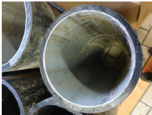
4.6. ábra: Koextrudált csövek natúr PE belső réteggel. Cső kód: G1
