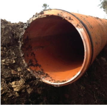
4.9.2. ábra: Átm. 160 mm-es szerkezeti falú, kiásott PP cső, Surnadal. Cső kód: N2
