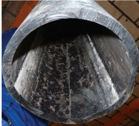
4.5. ábra: A szennyvízből származó lerakódások a cső belső felszínén jelzik a csatornacső elárasztott területét (folyásfenék). Cső kód: F1
